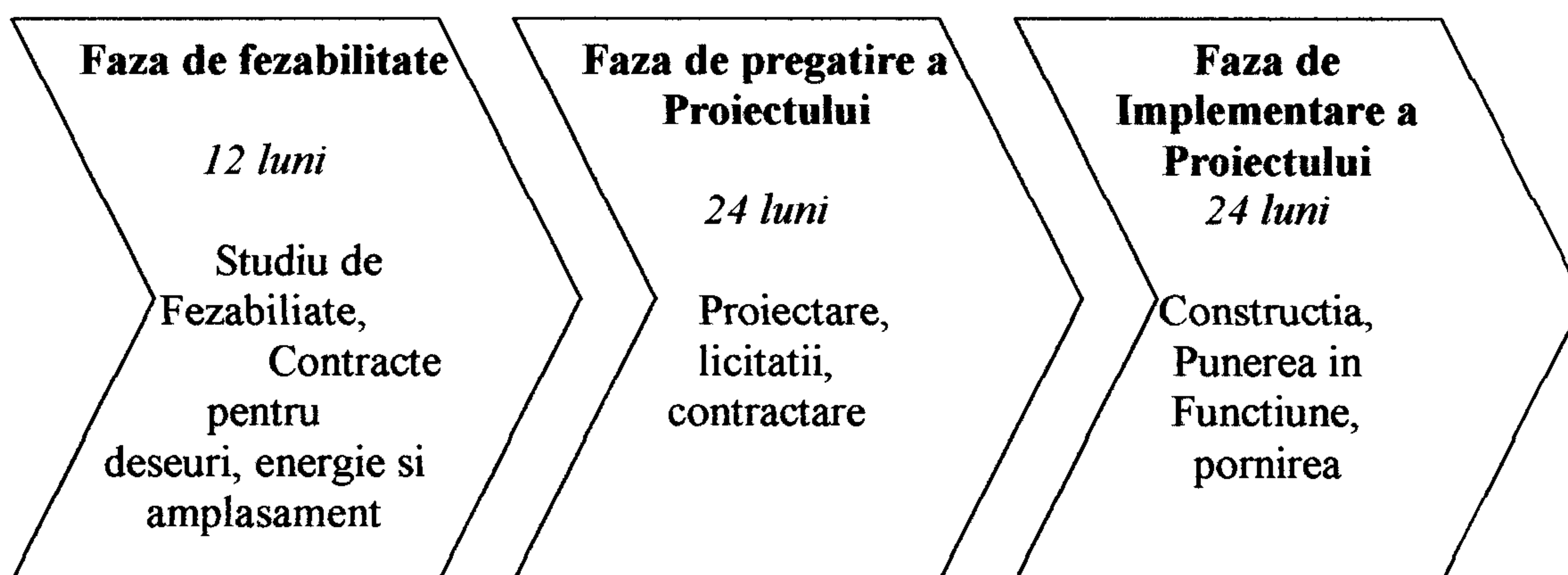
Fig. 1 – Schema generica a procesului de planificare si realizare a unui proiect de transformare a deseurilor in energie
